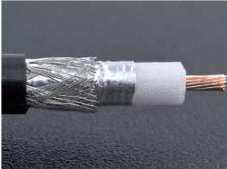
Das Low Loss Kabel H155 ist für den Frequenzbereich bis 3 GHz geeignet. Die HF-Leitung ist flexibel und für Anwendungen im Funkbereich empfehlenswert. Die guten Dämpfungswerte werden durch ein verlustarmes PE-Dielektrikum mit mehr als 50% Luftanteil, sowie durch Innenleiter und zweifach-Schirm aus Kupfer und Alu-kaschierter Folie erreicht.
