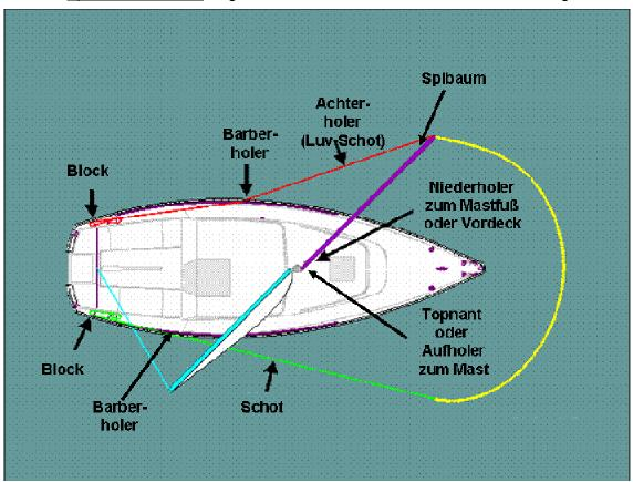
ter unten der Baum gestellt wird desto flacher wird das der Spi werden, je weiter oben umso bauchiger. Damit ergibt sich umso stärker der Wind desto weiter den Spibaum nach unten. Der <u>Barberholer</u> verändert den Winkel der Schot nach unten, damit kann das Leehorn des Segels nach unten gezogen werden, und damit auch flacher getrimmt werden. (Bei Schiffen mit niedrigem Großbaum wie bei der Soling wird der Barberholer zum Beseitigen von Unklarheiten zwischen Spischot und Großbaum verwendet.)
