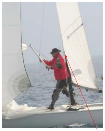
Zum Halsen mit dem Spinnaker muss lediglich der Spibaum geschiftet, d.h. auf der anderen Seite des Spinnakers angeschlagen werden. Bei kleinen Booten wird er dazu einfach vom Achterholer aus- und in die Spischot eingeklinkt.
